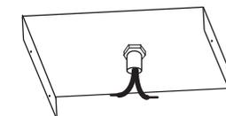
5 Elevar el artefacto y conectar los cables de 220vac en los bornes L, N y tierra. (no desenchufar los cables V+ y V-)
