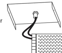
6 Colocar el florón con los tornillos en la ranura contra el techo y deslizar para fijarlo en la ranura horizontal. Luego ajustar los tornillos.
