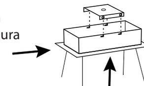
7 Regular altura e inclinación con los reguladores. Para acortar el tensor, empujar el cable hacia adentro del artefacto. Para alargar el tensor presionar el regulador hacia adentro y tirar del cable.
